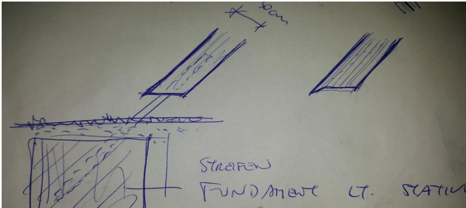
**Das Gebilde wird mittels 8cm dicken Niro-Stangen in sich zusammen gehalten als auch in Kombination eines Streifenfundamentes vom Boden abgehoben um die 30cm dickem Kreuzlagenholz (KLH)- Platten konstruktiv vor Wasserkontakt an den Kanten zu schützen. Eine sogenannte Wassernase erleichtert das abtropfen des Wassers an der Kante.**
