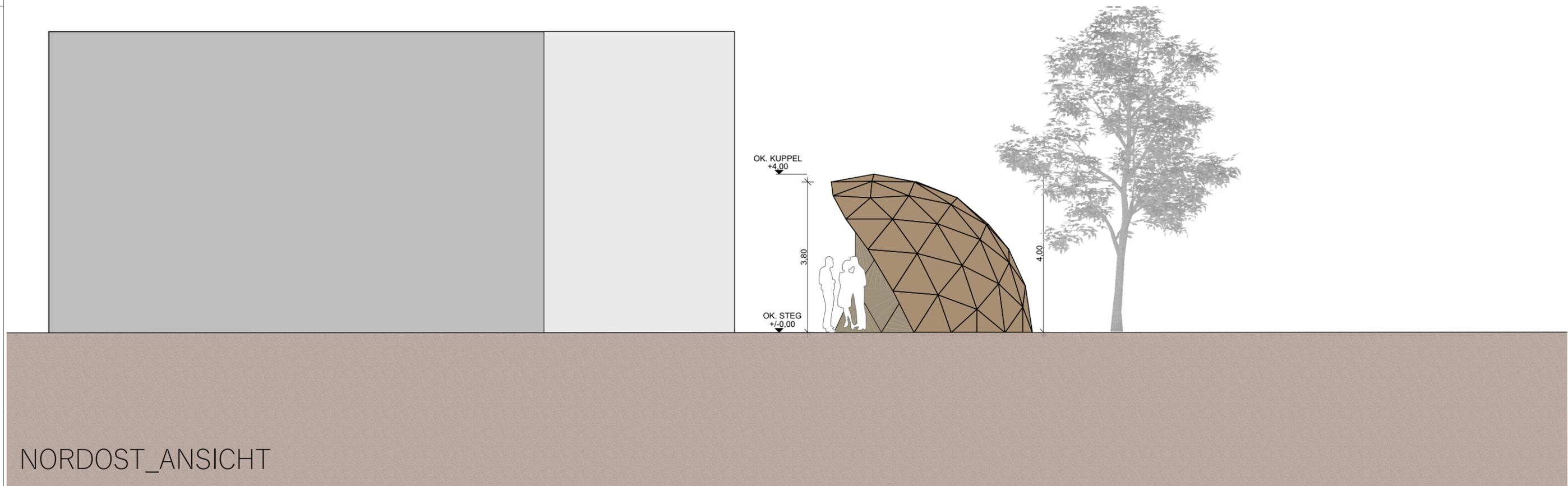
Die Halbkuppel Struktur ist aus Dreiecken zusammengesetzt und ermöglicht einen großen Innenraum. Sie ist frei von Säulen und sparsam im Materialgebrauch. Die Montage kann innerhalb eines Tages von zwei Handwerkern erfolgen.
